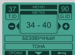
Метка дополняет функцию дискриминации: она позволяет создать “окно” между отсекаемыми целями, находящимися ниже установленного уровня дискриминации. Например, если Вы обнаружили ненужную цель в грунте, можно отсечь сектор проводимости определенного типа металла, из которого состоит нежелательная цель, и продолжать искать цели с проводимостью ниже или выше отсеченной группы.
