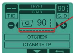
Индекс минерализации грунта (постоянно измеряемый для ориентирования).
