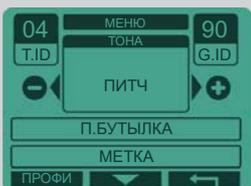
Режим **Питч** не связан с проводимостью цели: сила сигнала генерирует звук, который изменяется как по громкости, так и по высоте звуковой частоты. Это означает, что более отдаленная от катушки цель будет давать низкий слабый звук, тогда как более близкая цель даст высокий сильный звук. Режим **ПИТЧ** дает динамический сигнал. Это позволяет металлоискателю реагировать на цель быстрее. Однако это не оказывает серьезного влияния на скорость, меняется лишь тип аудиоотклика.
