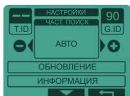
При каждой смене программы или частоты в программе MONO эта функция активирует автоматический поиск рабочих частот и указывает на чистый канал с наименьшими помехами. Поиск частот на **DEUS II** является особенно быстрым, однако при смене программы он может замедлить навигацию на 2 с.
