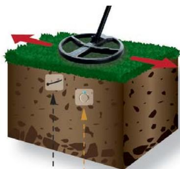
Например, при проводке катушки над железным предметом вблизи поверхности, а затем - над предметом из ценного металла (кольцом).
