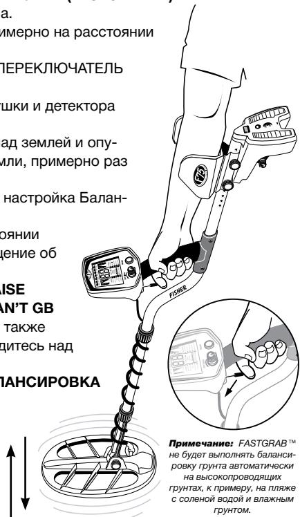
**Примечание:** FASTGRAB™ не будет выполнять балансировку грунта автоматически на высокопроводящих грунтах, к примеру, на пляже с соленой водой и влажным грунтом.
