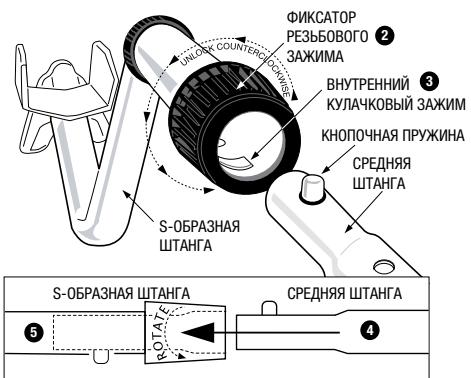
5. Поворачивайте СРЕДНИЮЮ ШТАНГУ до тех пор, пока КНОПОЧНАЯ пружина не окажется в отверстии.
