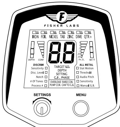
Использование Disc. Level (УРОВЕНЬ ДИСКРИМИНАЦИИ) совместно с функцией NOTCH дает вам значительную гибкость при принятии решений по поводу того, какие металлы (диапазоны металлов) включить, а какие исключить из процесса обнаружения. Имейте в виду, что данная комбинация может вас запутывать.
