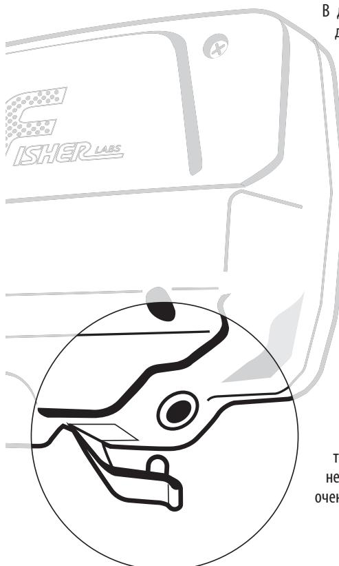
В данном металлоискателе используется разъём для наушников диаметром 6,25 мм (1/4 дюйма). Он может работать с любыми стереонаушниками (не входят в комплект поставки) с таким разъёмом. Когда подключены наушники, внешний динамик отключается. Работа с наушниками увеличивает срок работы от батареи, и звуковой сигнал прибора не мешает окружающим. По-мимо этого, наушники способствуют лучшей слышимости слабых сигналов.
