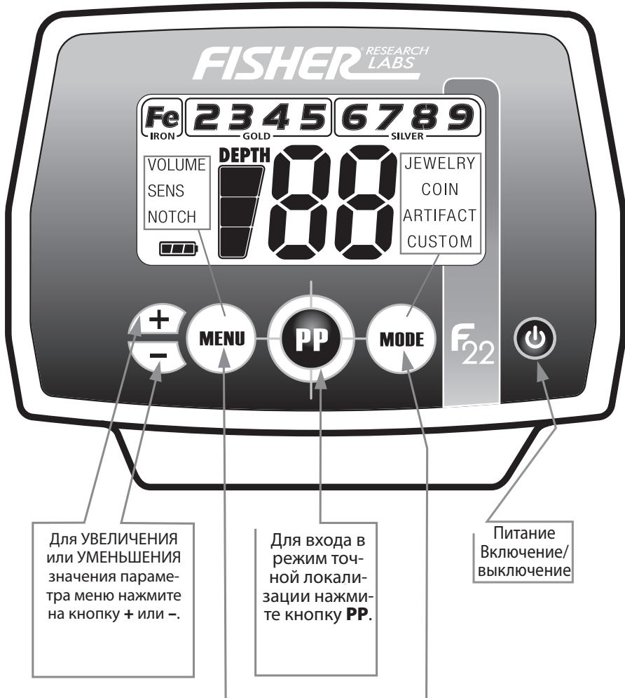
Повторные нажатия на кнопку **MENU** циклически перебирают опции: **VOLUME** (регулировка громкости), **SENSITIVITY** (регулировка чувствительности) или **NOTCH** (селективная дискриминация)
